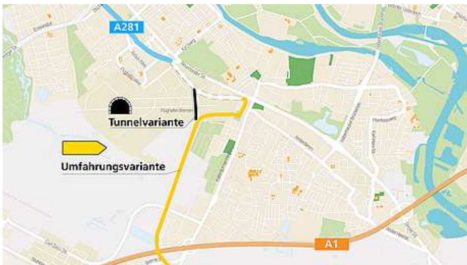
Der kleine gelbe Schlenker in der Mitte ist die Quelle der Diskussion: Entweder führt die (gelbe) B6n direkt an der am Wohnquartier Wolfskuhle vorbei, oder per Tunnel (schwarz) unter dem Flughafen durch. Quelle: Deges GmbH, März 2016
